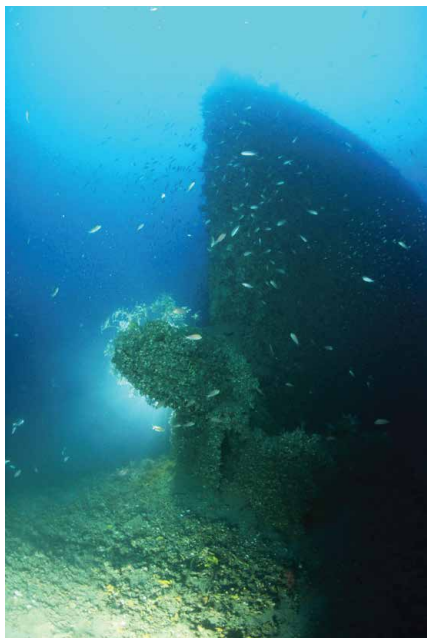
Slika 12. Re d'Italia , kljun na pramcu olupine broda (D. Gorički, arhiv HRZ-a)
