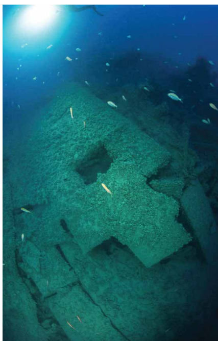
Slika 15. Re d'Italia , urušeni dio oplata na desnom boku olupine (D. Gorički, arhiv HRZ-a)
