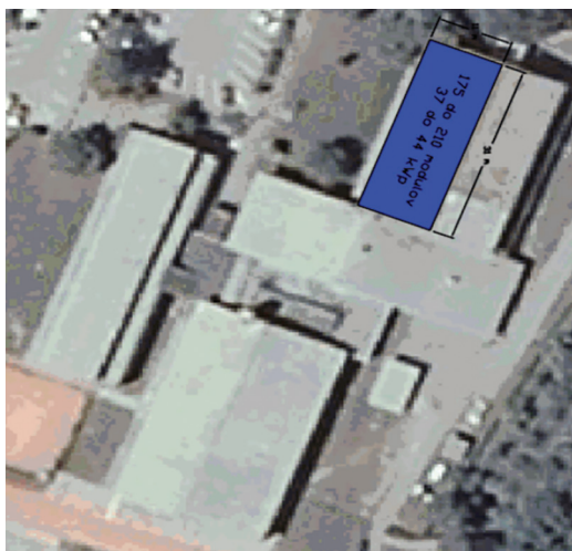
Slika 1. Krov škole na kojem je solarna elektrana (Gorenjske elektrarne, 2011)
