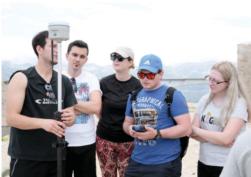
SLIKA 1. Prikupljanje lokacija pločica primjenom RTK GPS Stonex S10
